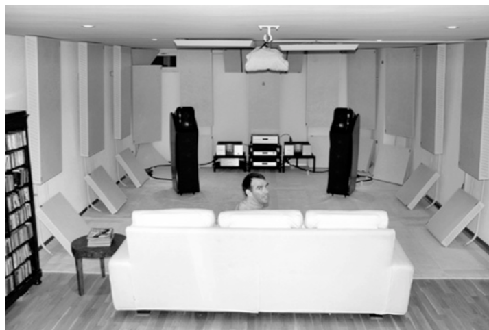
Hình 21.16: Căn phòng này đã xử lý mạnh bằng bẫy bass ở cả góc tường lẫn góc sàn, cộng với bảng có chân dày ở mặt trước và mặt bên để hấp thụ tần số rất thấp tốt.
