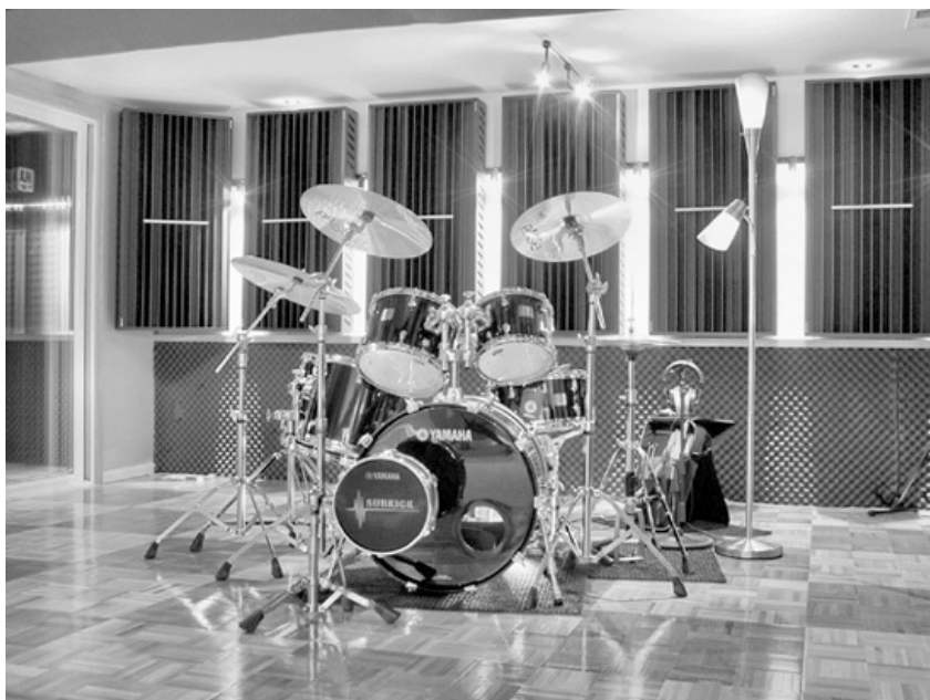
Hình 21.21: Phòng thu âm này sử dụng khuếch tán rộng để thu được âm thanh lớn, sống động, đồng thời tránh những phản dội kết hợp tạo ra lọc lọc.
