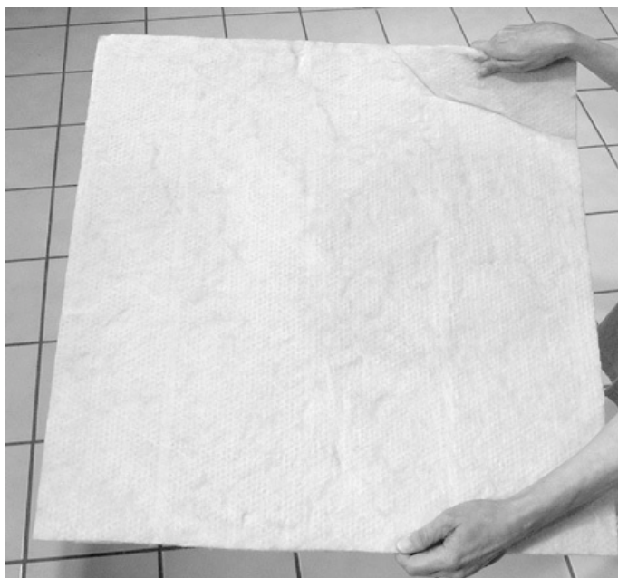
Hình 21.2: Sợi thủy tinh cứng Owens-Corning 703 không cứng như gỗ hay nhựa, nhưng nó giữ hình dạng khi không nặng đỡ và dễ cắt bằng dao bén.
