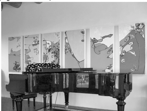
Hình 21.18: Bảng RealTraps trong phòng này đều sơn tùy ý bằng mực thay vì sơn thông thường để tránh làm giảm sự hấp thụ của nó ở tần số mid và high.
