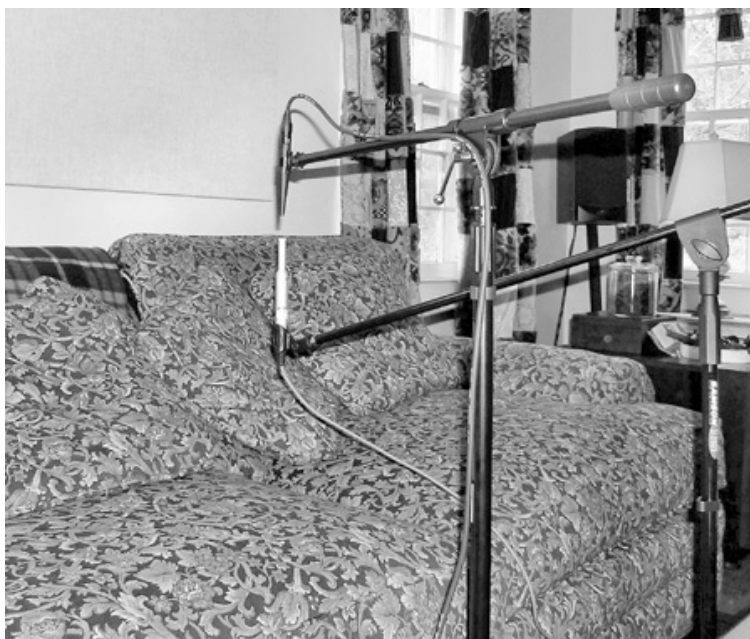
Hình 21.27: Cả hai micro đều đặt ở vị trí nghe, mặt đối mặt. Việc này cho phép đo phòng tại cùng một vị trí chính xác mà hệ thống Audyssey đã xử dụng để tạo ra đáp ứng tốt nhất.
